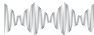
变频器次级侧的漏电流波形示意图 电流值反复增减。
