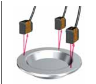
电池盖的平面度
